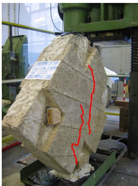
foto 9 – ruptura panoului nr. 17
