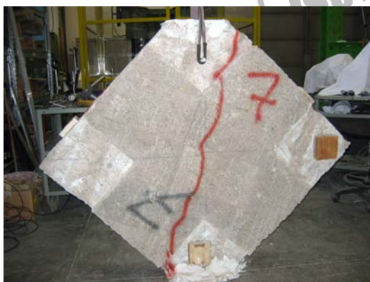
foto 7 – ruptura panoului nr. 7
