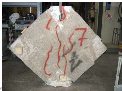
foto 6 – fisurarea cu rupere a panoului 7
